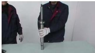
1. 在主轴前端（有螺纹端）套入前轴承
