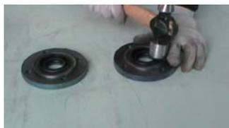
9. 用工具轻轻敲打轴承油封外圈，使其安装到位
