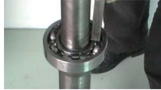
3. 用工具敲打轴承内圈，使其安装到位 ※注①
