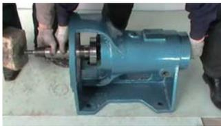
9. 用木锤轻轻敲打主轴，将前后轴承固定在轴承座内 ※注②
