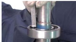
4. 用工具敲打轴承内圈，使其安装到位 ※注①
