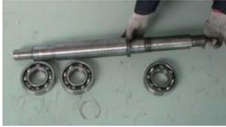
1. 在主轴前端（有螺纹端）套入轴承垫圈
