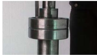
7. 用工具敲打轴承内圈，使其安装到位 ※注①
