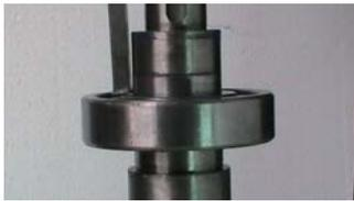
5. 用工具敲打轴承内圈，使其安装到位 ※注①
