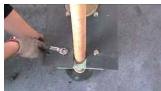
47. 安装出液管固定板，用螺栓将其与安装板连接紧固
