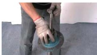
9. 将轴承支架从主轴叶轮端套入（端面高的一面朝上）
