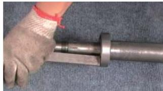
2. 用工具敲打下轴承内圈，使其安装到位
