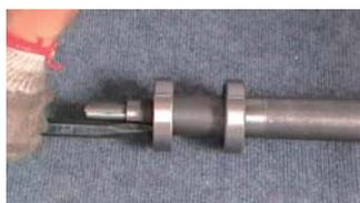
5. 用工具敲打上轴承内圈，使其安装到位
