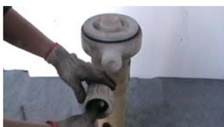
45. 在出液管连接套圈内装入密封垫
