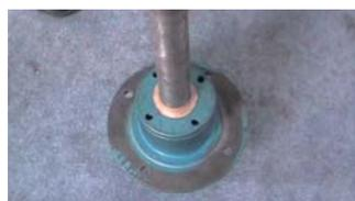
15. 套入防砂密封圈（内侧唇边朝外）
