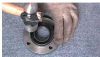
7. 分别在上下轴承侧盖内敲入轴承油封，放上青壳纸垫
