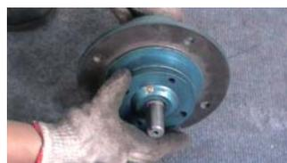
12. 装入上轴承侧盖（侧盖外端有凸起并有注油孔）
