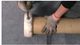
26. 固定连接筒，防止转动，将泵壳拧紧
