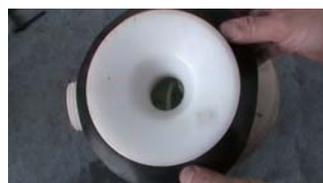
43. 在泵盖端装入泵盖垫
