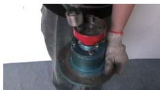
18. 安装主轴联轴器，用工具轻轻敲击，使其安装到位
