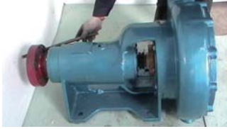
25. 用工具固定联轴器，防止 主轴转动
