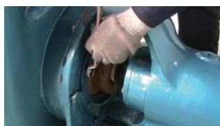
22. 固定密封盒压盖，用螺栓将其与泵壳对角均匀拧紧
