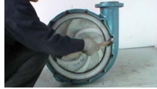
27. 用工具轻轻敲击叶轮，使 其安装到位
