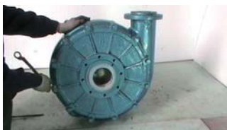
41. 用螺栓将其与泵壳连接， 并对角均匀拧紧 ※注②
