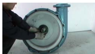
23. 在主轴前端套入副叶轮L垫
