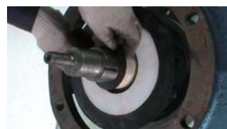
16. 套入叶轮垫（轴套垫）
