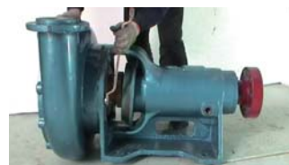
20. 用螺栓将泵壳与轴承座连接，并对角均匀拧紧
