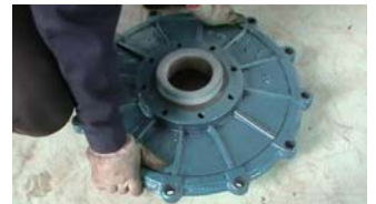
36. 在泵盖上装上泵盖压板
