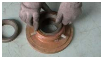
2. 装入第二只K形密封圈（唇口朝下）
