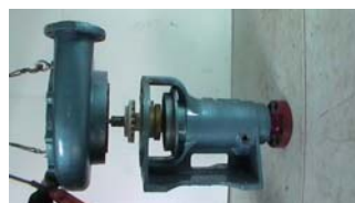
19. 使用起吊设备将泵壳安装到轴承座上
