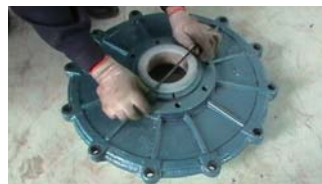
38. 套上O形圈将其固定
