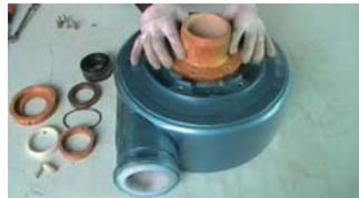
3. 装上密封盒（注意冷却水孔水平对称朝斜上方）
