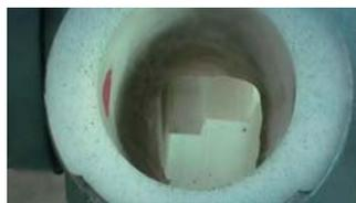
22. 同时从泵出口处观察叶轮背叶与泵壳的间隙，将其调节到3mm左右
