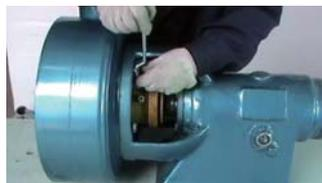
18. 用螺栓将泵壳组件与轴承座连接，并对角均匀拧紧
