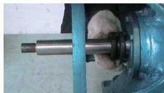
15. 在主轴上依次旋上两只主轴拼帽（旋至螺纹露出）
