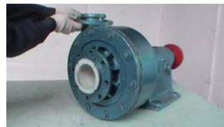
39. 在泵出口处套入出口活套法兰
