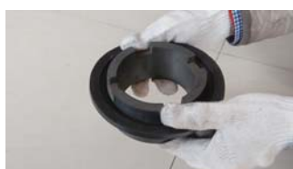
5. 将锥形密封圈（唇口朝向静环摩擦面）套入静环
