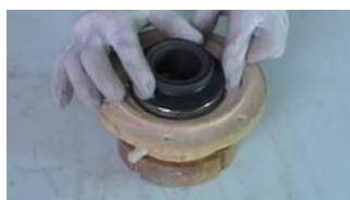
14. 对齐卡槽装入静环组合件
