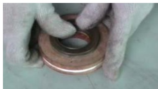
1. 在弹簧座一端装入冷却水封
