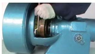
23. 用螺栓将其与轴承座连接，并对角均匀拧紧
