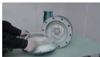
39. 在泵盖上装入泵盖垫
