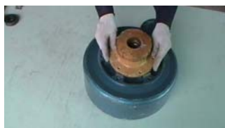
17. 放入密封盒组件（注意冷却水嘴水平对称朝斜上方）
