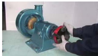
32. 固定联轴器，防止主轴转动
