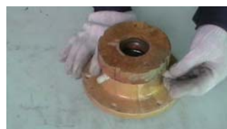
12. 在密封盒侧面拧入两只冷却水嘴 ※注①
