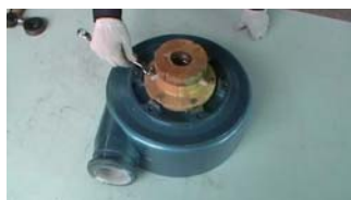
18. 用螺栓将其与泵壳连接，并对角均匀拧紧
