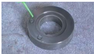
25. 在动环摩擦面滴上适量润滑油，并涂抹均匀
