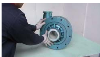
41. 装上泵盖压紧圈
