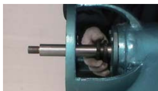
19. 在主轴上依次旋上两只主轴拼帽（至螺纹露出）
