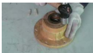
10. 用工具将弹簧座组合件轻轻敲入密封盒内压平整
