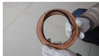
4. 在O形圈垫块内侧装入O形圈
