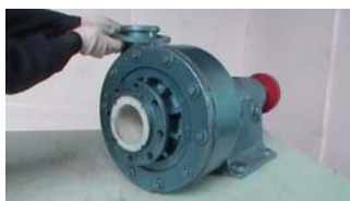
45. 在泵出口处套入出口活套法兰
