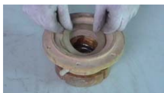
13. 在密封盒另一端装入O形圈垫块垫床
