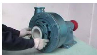
43. 在泵盖上套入进口活套法兰
