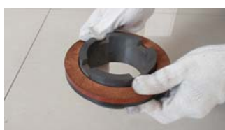
6. 将O形圈垫块（有台阶面朝向锥形密封圈台阶）套入静环
