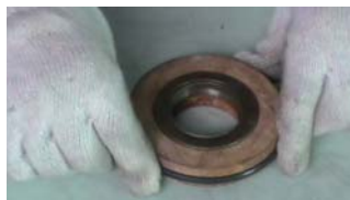
3. 在弹簧座外侧装入O形圈
