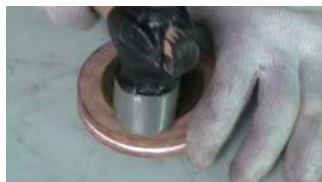
2. 用工具将冷却水封轻轻敲击压实
