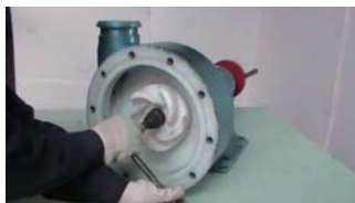
33. 用专用工具拧紧防转螺母，使叶轮向里压缩2~2.5mm
