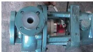
25. 固定叶轮轴端的两只螺栓
