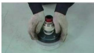
11. 将动环插入叶轮轴，使动环摩擦面接触
