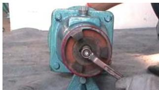
18. 拧紧穿轴螺杆，使其与叶轮轴内螺纹连接紧固
