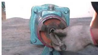
17. 将穿轴螺杆从联轴器端插入主轴内孔
