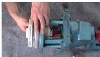
21. 在泵盖端装上泵盖垫
