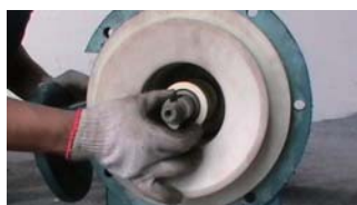
23. 套入叶轮顶圈
