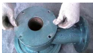
12. 安装密封盒压盖（内侧有台阶端朝下）
