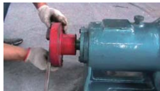
29. 固定联轴器, 防止主轴转动
