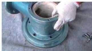
2. 在后泵盖上安装吸入口三通接管
