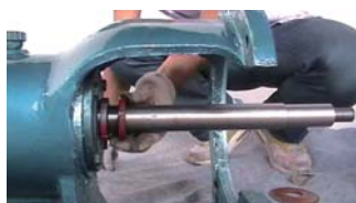
14. 在主轴上依次旋上两只主轴拼帽（至螺纹露出）
