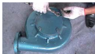
38. 用螺栓与泵壳连接, 并对角均匀拧紧
