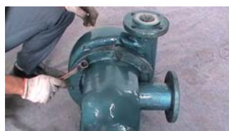
43. 对角均匀拧紧泵壳与轴承座的连接螺栓 ※注③
