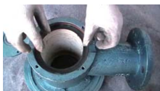
10. 在吸入口三通接管上放置密封盒垫
