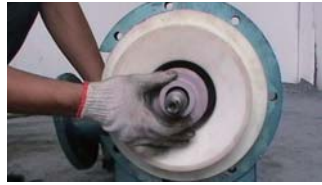
20. 套入减压副叶轮（有叶片的一面朝内）
