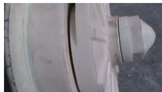
34. 检查叶轮与后泵盖之间的间隙 ※注②
