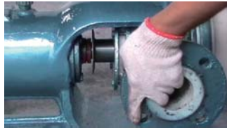
18. 装上装配好的吸入口三通接管组件
