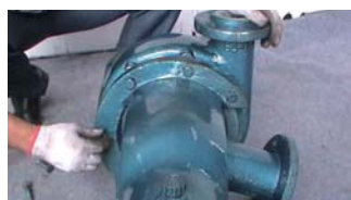
41. 用螺栓连接, 注意: 此时无需将螺栓拧紧!
