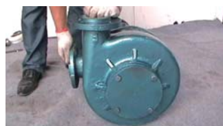
42. 将吸入口三通接管调节至水平位置
