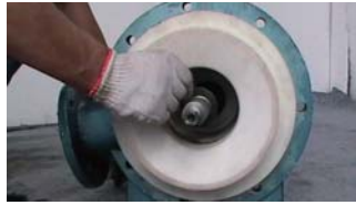
19. 在主轴前端套入减压副叶轮垫
