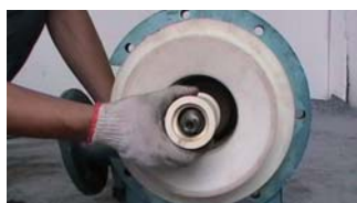
22. 套入前轴套（台阶深的一端朝外）
