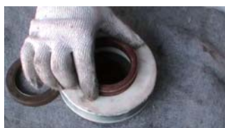
6. 装入水封环（外侧有台阶端朝上）
