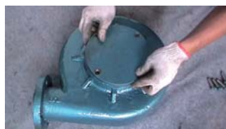
37. 装上闷盖压板
