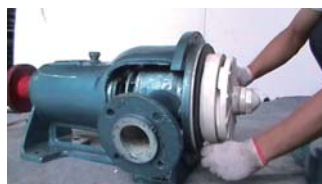
39. 在后泵盖上套入后泵盖垫
