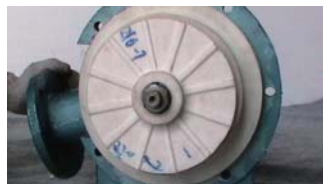
28. 逆时针方向旋上防转螺母
