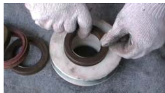
4. 在密封盒中装入第一只K形密封圈（唇口向下）
