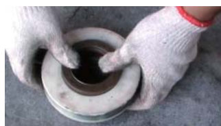
8. 装入第三只K形密封圈（唇口向下）
