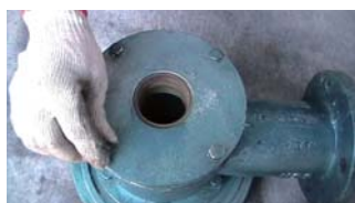
10. 用螺栓将其连接，注意：此时无需将螺栓拧紧！
