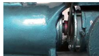
44. 对角均匀拧紧密封盒压盖上的紧固螺栓
