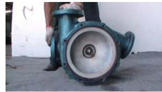
28. 将吸入口三通接管调节至水平位置
