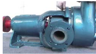
27. 用螺栓连接，注意：此时无需将螺栓拧紧
