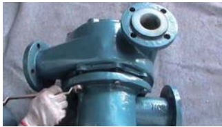
29. 对角均匀拧紧泵壳与轴承座的连接螺栓
