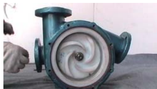
34. 逆时针方向旋上防转螺母
