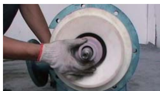
17. 套入减压副叶轮（有叶片的一面朝内）
