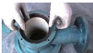
7. 在吸入口三通接管上放置密封盒垫
