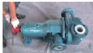
35. 固定联轴器，防止主轴转动
