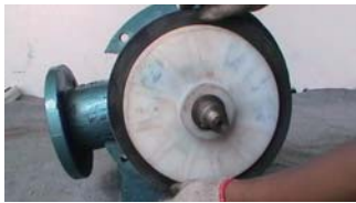
25. 在后泵盖上套入后泵盖垫
