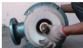
20. 套入叶轮顶圈
