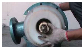
19. 套入前轴套（台阶深的一端朝外）
