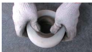
6. 装入第三只K形密封圈（唇口向下）
