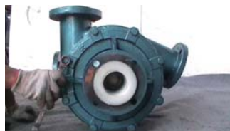
42. 用螺栓与泵壳连接，并对角均匀拧紧 ※注②
