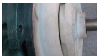
24. 检查一级叶轮与后泵盖之间的间隙 ※注①
