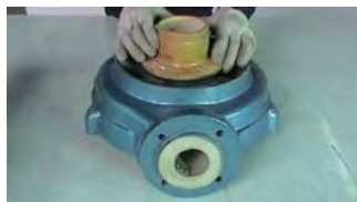
3. 装上密封盒（注意冷却水孔左右对称朝斜上方）
