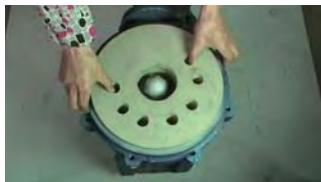
29. 再将挡板逆时针旋转10~15°
