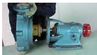
16. 将泵壳组件装入主轴套垫
