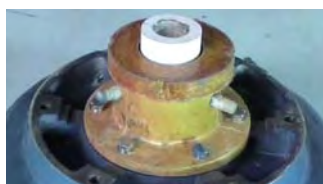
14. 将轴套插入密封盒（K形密封圈）内
