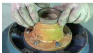
6. 装入第二只K形密封圈（唇口朝下）
