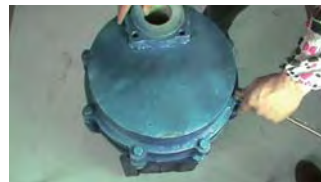
32. 用螺栓将泵盖与泵壳连接, 并对角均匀拧紧 ※注③
