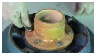
4. 用螺栓将密封盒与泵壳连接，并对角均匀拧紧
