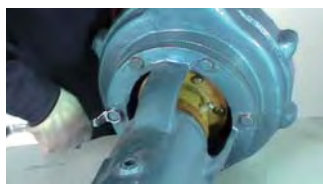
17. 用螺栓将泵壳组件与轴承座连接，并对角均匀拧紧
