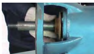
15. 在主轴上套入挡酸片、轴套垫
