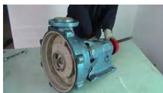
23. 固定联轴器，防止主轴转动
