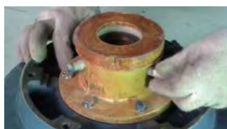
13. 在密封盒侧端装上两只冷却水嘴 ※注①
