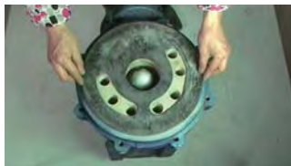
30. 在挡板上放上泵盖垫, 注意对准回流孔位置
