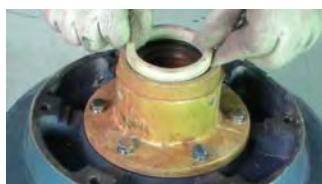
11. 装入顶圈（外侧有台阶面朝下）
