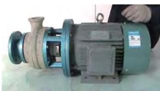
21. 直联式泵安装穿轴螺栓，要先拆下电机风罩
