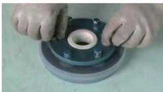
5. 用螺栓将静环压盖与泵盖连接，用手对角均匀拧紧至受力
