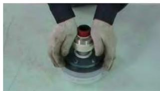
10. 将动环插入叶轮轴，使动环静环摩擦面接触
