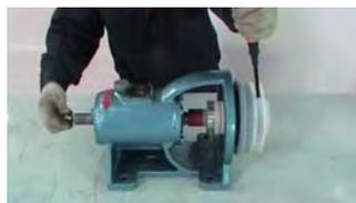
14. 在穿轴螺栓末端旋上两只螺母
