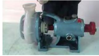
27. 用螺栓将泵壳与轴承座连接，并对角均匀拧紧
