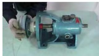
11. 将叶轮轴插入主轴（直联式泵轴为电机轴）
