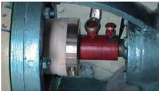
33. 调整好叶轮前后位置后，固定叶轮轴端的两只螺栓
