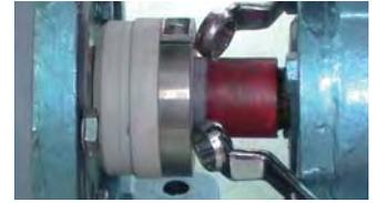
28. 正确调整动环弹簧的压缩量 ※注②
