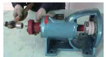
20. 用工具轻轻敲击将键安装到位
