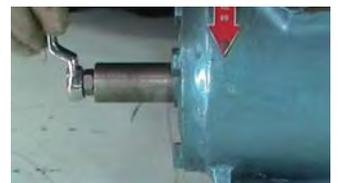
16. 拧紧穿轴螺栓，使其与叶轮轴内螺纹连接紧固
