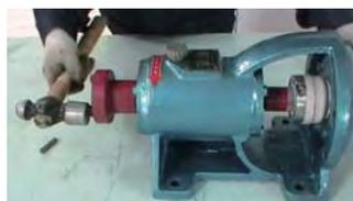
18. 用工具轻轻敲击将联轴器安装到位
