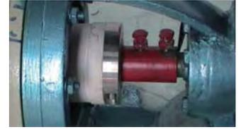
32. 部分泵型可以通过前后移动叶轮轴调节叶轮 ※注③
