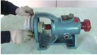
25. 在泵盖端装入O形密封圈
