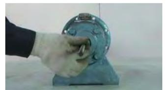
12. 用穿轴螺栓从联轴器端插入主轴内孔
