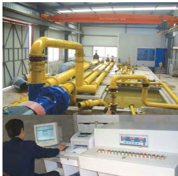
▲ 8000m 3 /h泵全性能测试台
