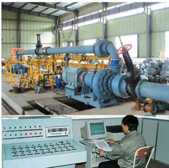
▲ 2000m 3 /h泵全性能测试台
