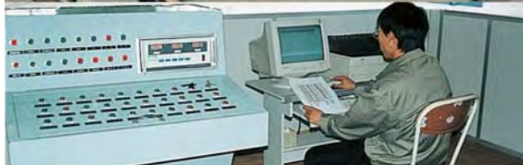
▲ 2000m 3 /h泵全性能测试台
